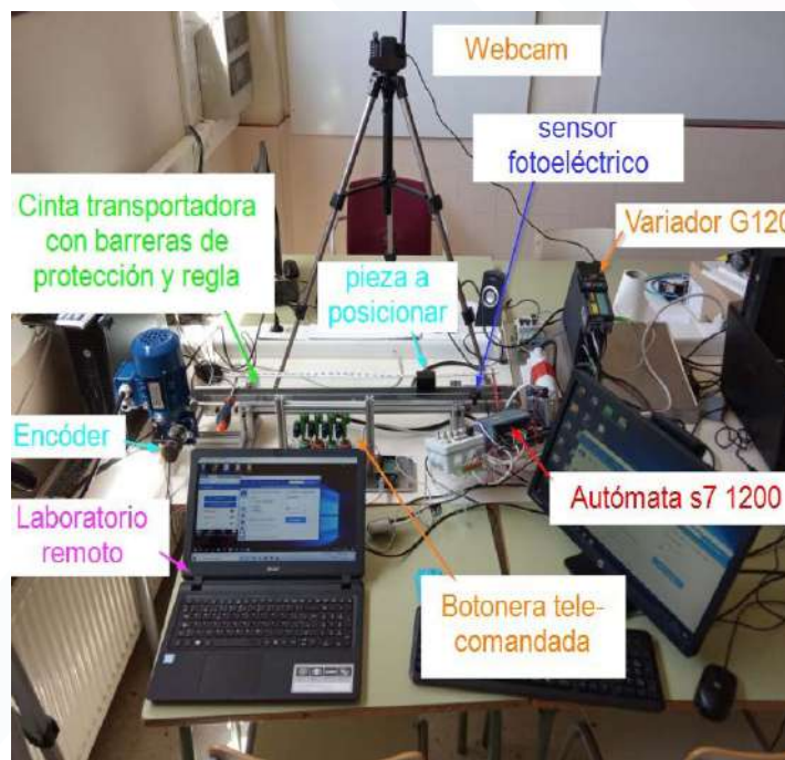
Figura 1. Montaje práctica 2: automatización cinta transportadora. Fuente: Elaboración propia.
